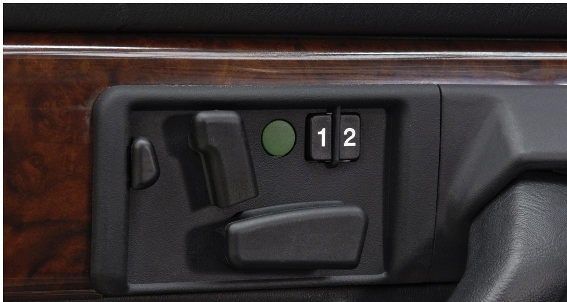
Ein Knopfdruck - die Sitzposition stimmt wieder. Die Memory Schaltung kann zusätzlich zur elektrischen Sitzverstellung eingebaut werden. Sie ermöglicht die exakte Speicherung von zwei unterschiedlichen Einstellungen der Sitz- und Kopfstützenpositionen, die über die elektrische Sitzverstellung vorgewählt wurden.
