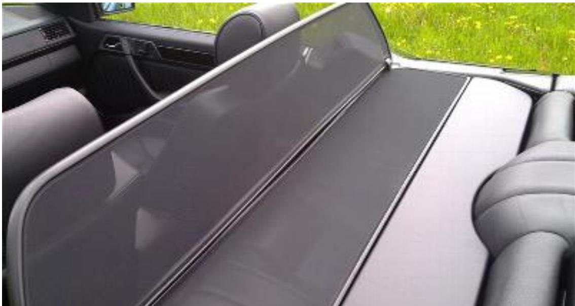
Jeder Cabrio Fahrer kennt das Problem: Plötzlich wird die Fahrt durch unangenehme Zugluft getrübt. Doch dafür gibt es eine Lösung: Das Windschott (SA 283). Es schützt Fahrer und Beifahrer zuverlässig vor störender Zugluft von hinten und macht das Cabrio fahren deutlich angenehmer. Besonders für weibliche Cabrio Fahrer ist ein Windschott unverzichtbar, da es das Wehen der Haare verhindert, was beim Fahren sehr störend sein kann.
